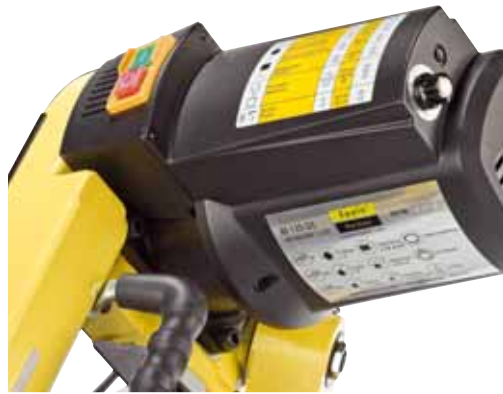
Am Motorblock wird mithilfe des Drehstellers die gewünschte Geschwindigkeit vorgewählt
