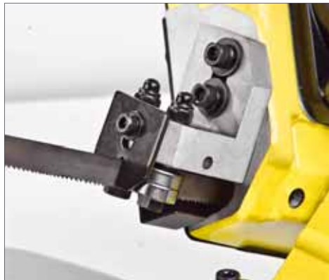
Eine präzise Rollenführung sorgt für beste Schnittergebnisse
