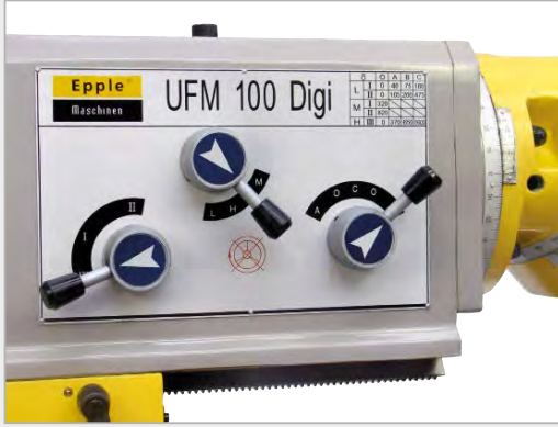
11 ayrı mil hız ayarı için kontrol panosu
