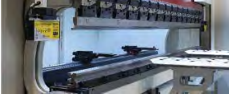
RESIM.: ÇALIŞMA ALANI (E-GBP 2.550-120) ÖZEL AKSESUARLAR İLE HIZLI DEĞİŞTİRME TUTUCULARI VE SAC KALDIRMA TUTUCUSU
