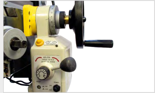
Y-ekseni kademesiz besleme için ayarlanabilir
