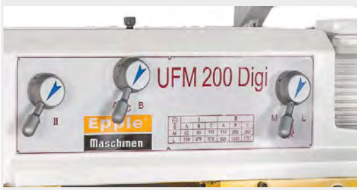
12 ayrı mil hız ayarı için kontrol panosu
