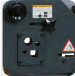
Çubuk Çelik İstasyonu ve malzeme aşağı tutanağı ile
