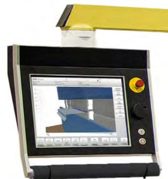
IMAG.: MONITOR PARA LAS PRENSAS DE FLEXIÓN
