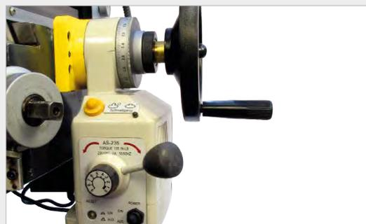
Eje Y con ajuste de avance sin fases
