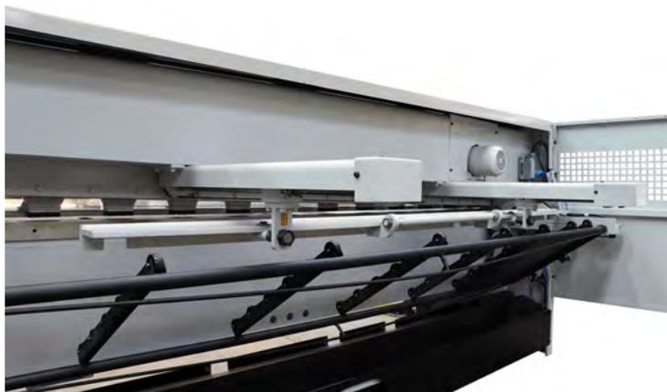
IMAG.: E -MTSK 3.060-4,0 EXPULSIÓN DE LA HOJA HACIA ADELANTE (PUESTA EN EXPULSIÓN FRONTAL)
