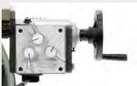
En serie con avance mecánico para la eje X con 8 velocidades
