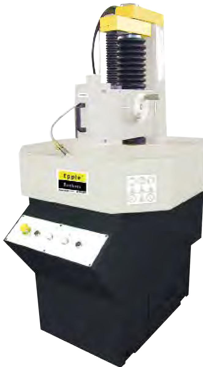
Rectificadora plana manual con husillo vertical y muelas rectificadoras de copa. Operación fácil y sensible a través el brazo orientable. Con dispositivo de medio refrigerante adecuado para el rectificado en mojado y en seco.
