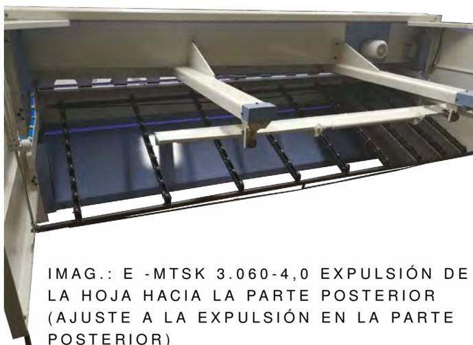
IMAG.: E -MTSK 3.060-4,0 EXPULSIÓN DE LA HOJA HACIA LA PARTE POSTERIOR (AJUSTE A LA EXPULSIÓN EN LA PARTE POSTERIOR)
