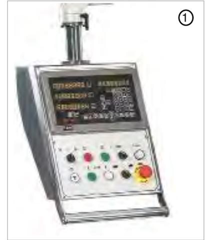
Pantalla LED digital clara y fácil de manejar está montada en la fábrica para la indicación exacta y medición de los recorridos de desplazamiento.
