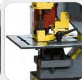
Estación de perforación capacidad máx. 28 x 15 mm y 38 x 11 mm
