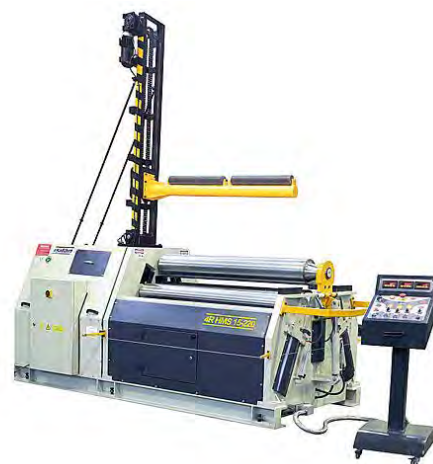
IMMAG.: E-4RBM PRO HMS 1.550-8,0 OPZIONALE CON SUPPORTO MECCANICO A GRANDE RAGGIO
