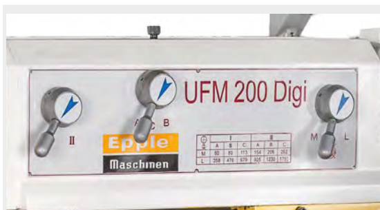
Unità di controllo per l'impostazione delle 12 velocità del mandrino
