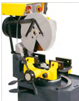
IMMAG.: Testa ruotata di 90 ° per la scanalatura
