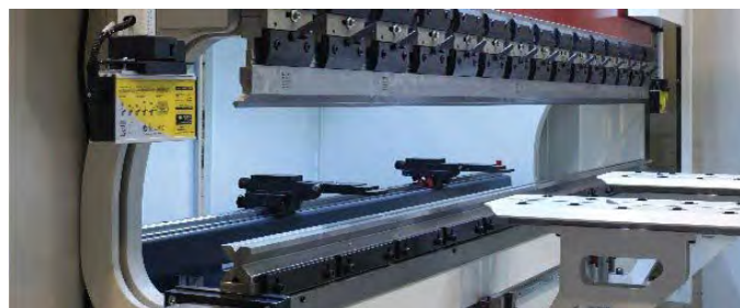
IMMAG.: AREA DI LAVORO PRESSA PIEGATRICE (GBP 2.550-120) CIB ACCESSORI SPECIALI SUPPORTO IN ACCIAIO CAMBIO RAPIDO E PREMILAMIERA
