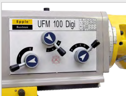
Pannello di controllo per la regolazione delle 11 velocità del mandrino.
