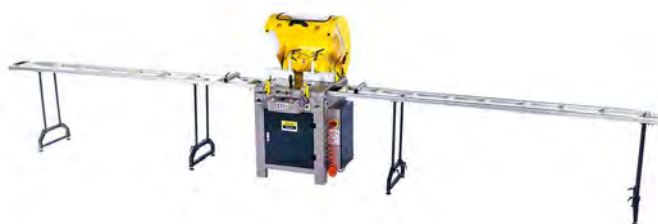
IMMAG.: CON TRASPORTATORI A RULLI OPZIONALI A DESTRA E SINISTRA
