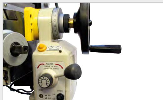
Asse Y con regolazione continua dell'avanzamento
