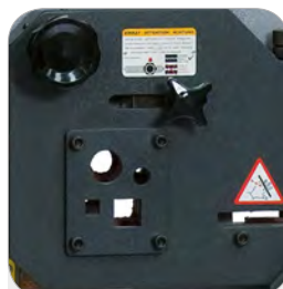
Stangenstahlstation mit Niederhalter
