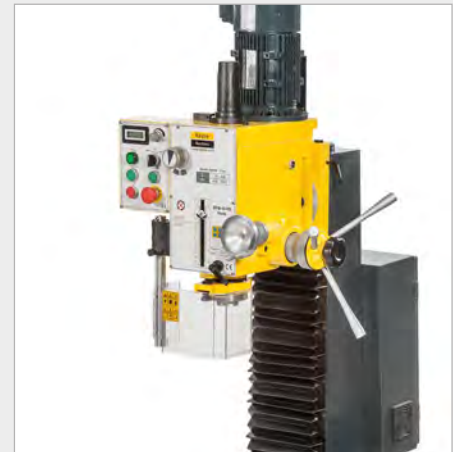
Übersichtliche Bedieneinheit mit Gewindeschneideinrichtung
