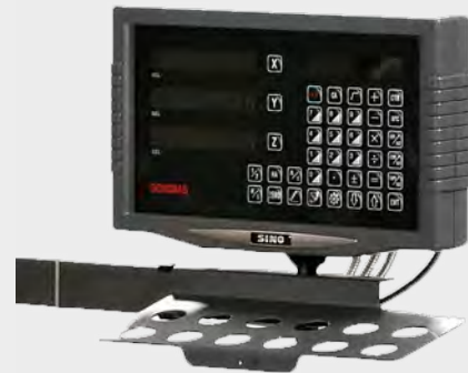
Werkseitig montierte, übersichtliche und bedienungsfreundliche digitale LED-Anzeige zur exakten Anzeige und Vermessung der Verfahrswege. Nur bei Maschinen in DIGI-Ausführung.
