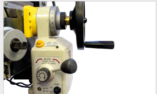
Y-Achse mit stufenloser Vorschubverstellung
