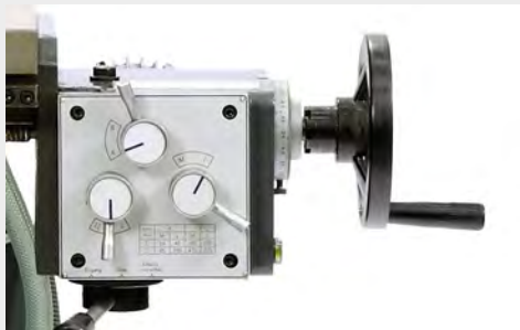
Serienmäßig mit automatischem Vorschub für die X-Achse mit 8 Geschwindigkeiten
