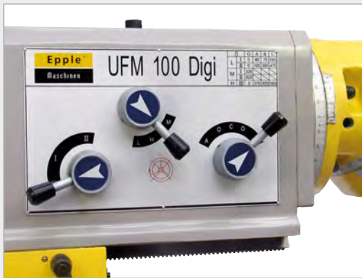
Bedieneinheit zur Einstellung der 11 Spindeldrehzahlen
