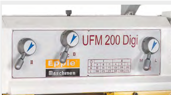
Bedieneinheit zur Einstellung der 12 Spindeldrehzahlen
