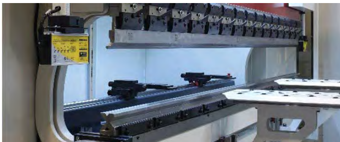
ABB.: ARBEITSRAUM GESENKBIEGEPRESSE (GBP 2.550-120) MIT SONDERZUBEHÖR SCHNELLWECHSELHALTER UND BLECHHOCHHALTER
