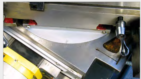
Kreuztisch 45° nach links und 45° nach rechts drehbar
