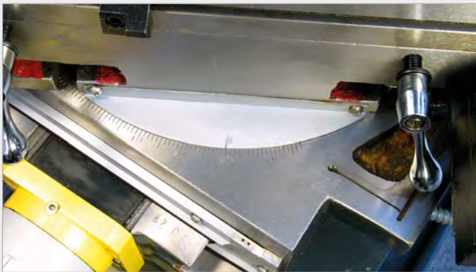
Kreuztisch 45° nach links und 45° nach rechts drehbar.
