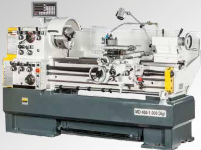
Leit- und Zugspindeldrehmaschine in schwerer Ausführung mit umfangreicher Serienausstattung. Vibrationsarm und laufruhig. Inklusive massivem Unterbau und Maschinenbett.
