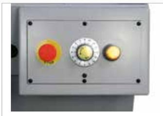
Der hydraulische Absenkszylinder kann stufenlos über ein Handrad eingestellt werden
