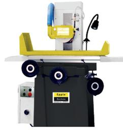
Flach- und Polierschleifmaschine, S. 149
