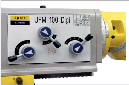
Bedieneinheit zur Einstellung der 11 Spindeldrehzahlen
