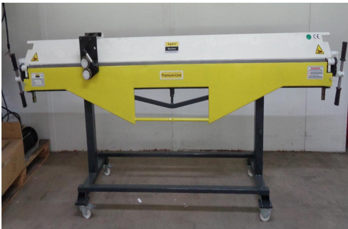
Manuelle Abkantbank mit zusätzlicher Blechschere um dünne Bleche bis 0,8 mm (auch z.B. Kupfer, Aluminium oder Zinkblech) in einem Arbeitsgang zu Kanten und Schneiden.
