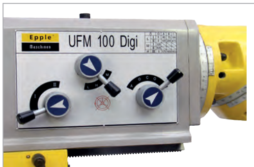
Bedieneinheit zur Einstellung der 11 Spindeldrehzahlen
