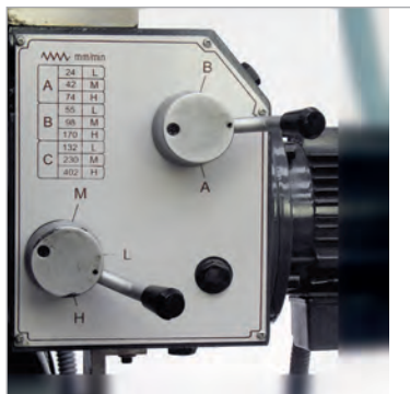
X- und Y-Achse mit 9 Geschwindigkeiten
