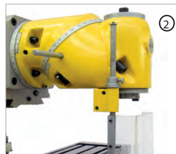
Werkseitig montierte übersichtliche und bedienungsfreundliche digitale LED-Anzeige zur exakten Anzeige und Vermessung der Verfahrswege.
