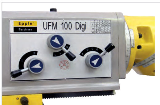
Bedieneinheit zur Einstellung der 11 Spindeldrehzahlen
