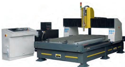
Präzisions-Plasmaschneidmaschine, S. 248
