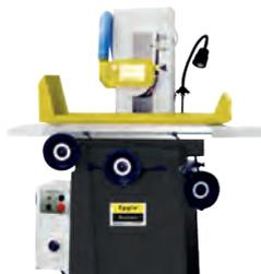
Flach- und Polierschleifmaschine, S. 149
