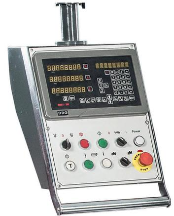
Werkseitig montierte übersichtliche und bedienungsfreundliche digitale LED-Anzeige zur exakten Anzeige und Vermessung der Verfahrswege.
