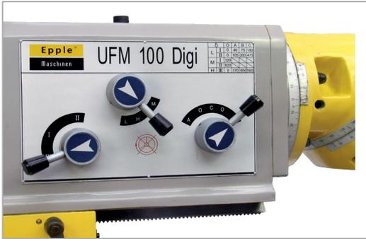
Bedieneinheit zur Einstellung der 11 Spindeldrehzahlen
