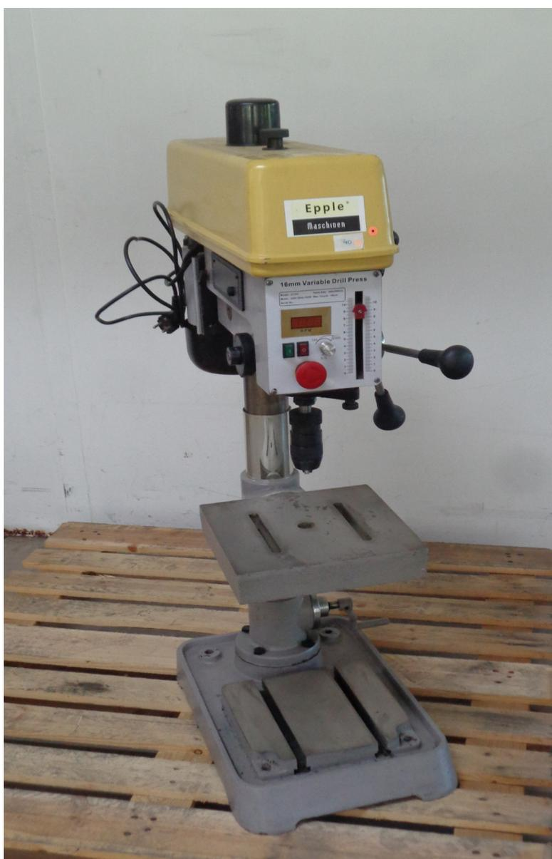
Bohrmaschine 16 mm
