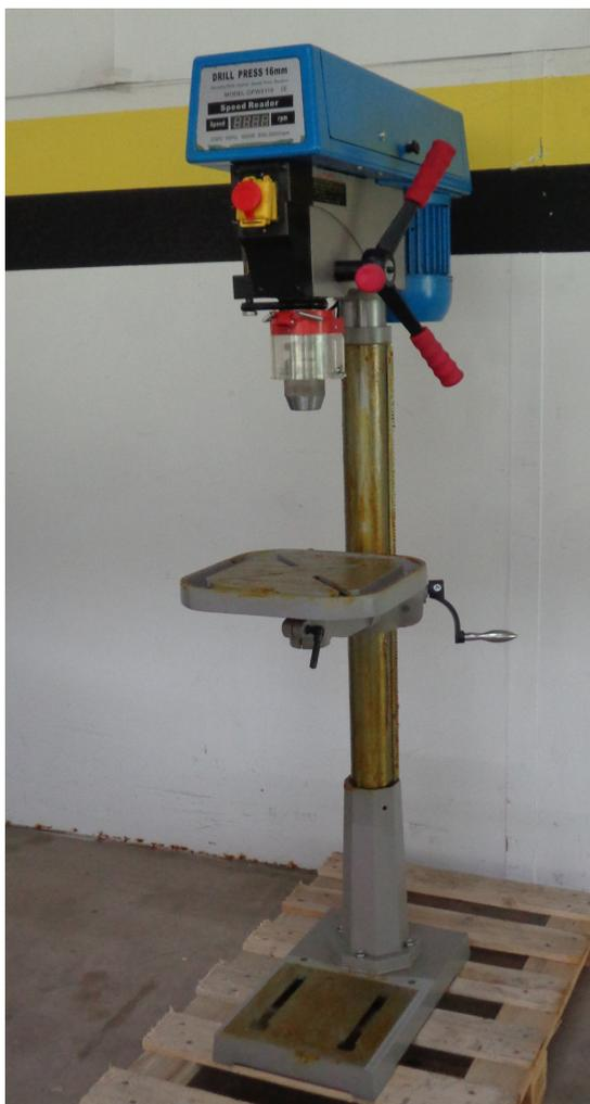
Bohrmaschine 16 mm
