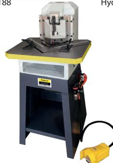
Manuelle Ausklinkmaschine, S. 231
