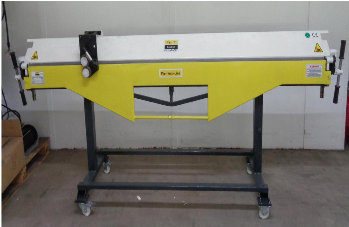
Manuelle Abkantbank mit zusätzlicher Blechschere um dünne Bleche bis 0,8 mm (auch z. B. Kupfer, Aluminium oder Zinkblech) in einem Arbeitsgang zu Kanten und Schneiden.
