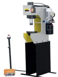
Vertikale Hydraulikpresse, S. 267
