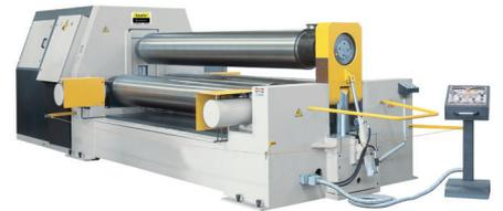
Hydraulische 3-Walzen-Rundbiegemaschine, S. 191
