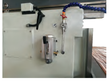
PIC.: central lubrication
