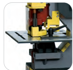
Lochstanzstation Max. Kapazität 28 x 15 mm und 38 x 11 mm
