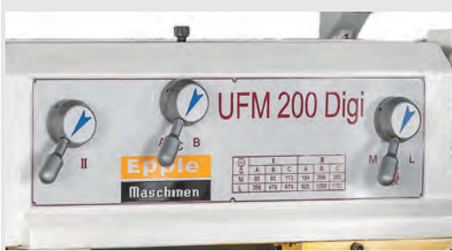
Bedieneinheit zur Einstellung der 12 Spindeldrehzahlen
