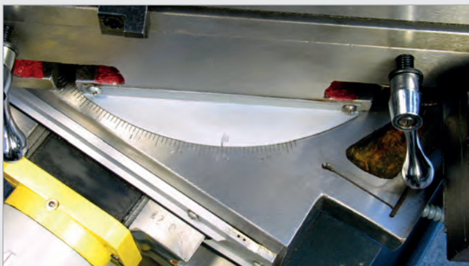
Kreuztisch 45° nach links und 45° nach rechts drehbar.
