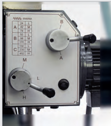
X- und Y-Achse mit 9 Geschwindigkeiten
