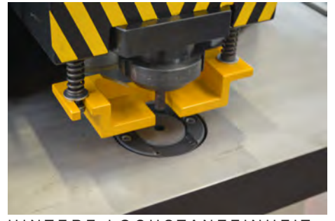
HINTERE LOCHSTANZEINHEIT NUR BEI MODELL E-HAM 6 VP
