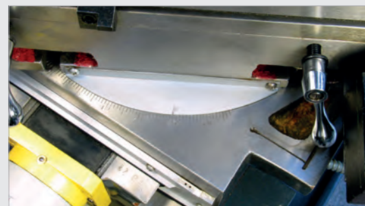
Kreuztisch 45° nach links und 45° nach rechts drehbar
