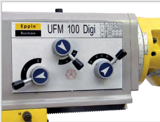
Bedieneinheit zur Einstellung der 11 Spindeldrehzahlen
