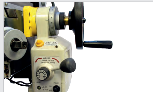
Y-Achse mit stufenloser Vorschubverstellung
