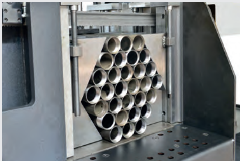
Hexagonalschraubstücke zum Bündeln von Rohren
