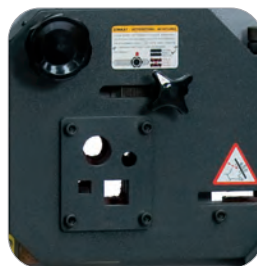
Stangenstahlstation mit Niederhalter
