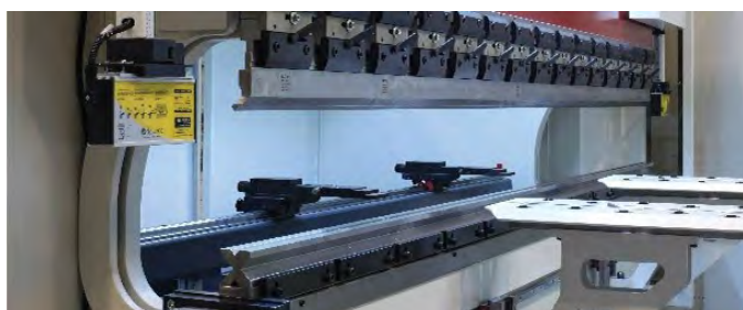
ABB.: ARBEITSRAUM GESENKBIEGEPRESSE (GBP 2.550-120 CNC) MIT SONDERZUBEHÖR SCHNELLWECHSELHALTER UND BLECHHOCHHALTER
