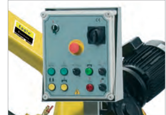
Drehbares und ergonomisch gestaltetes Bedienpult
