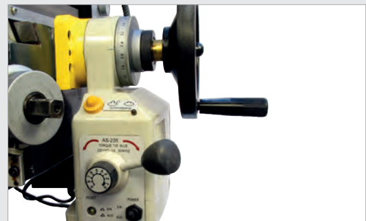
Y-Achse mit stufenloser Vorschubverstellung
