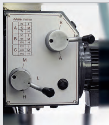
X- und Y-Achse mit 9 Geschwindigkeiten
