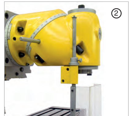
Werkseitig montierte übersichtliche und bedienungsfreundliche digitale LED-Anzeige zur exakten Anzeige und Vermessung der Verfahwege.
