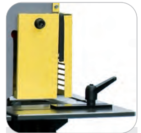
Ausklinkstation Tisch mit Anschlag und Skalen
