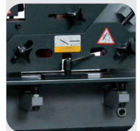
Flachstahlstation Tisch mit Winkelanschlügen und einstellbarem Niederhalter
