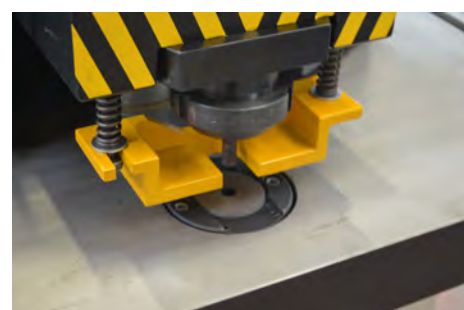
HINTERE LOCHSTANZEINHEIT NUR BEI MODELL E-HAM 6 VP
