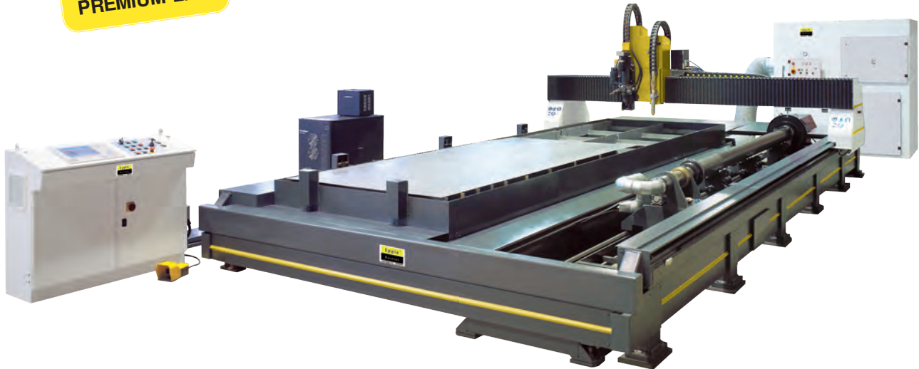
ABB.: E-IPSM 3012 MIT SONDERZUBEHÖR ZWEITER SCHNEIDKOPF
