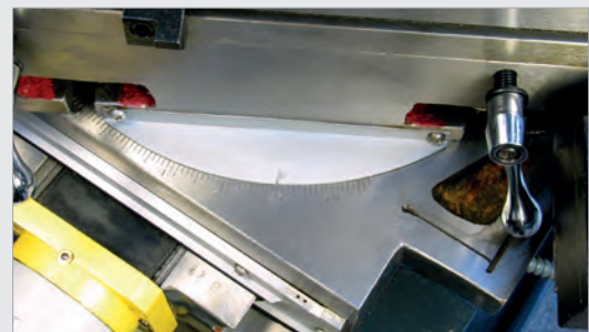
Kreuztisch 45° nach links und 45° nach rechts drehbar
