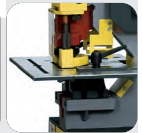
Lochstanstation Max. Kapazität 28 x 15 mm und 38 x 11 mm
