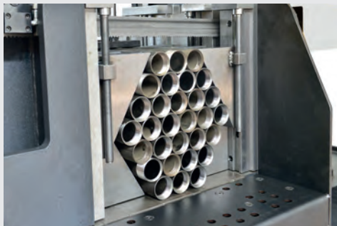
Hexagonalschraubstöcke zum Bündeln von Rohren
