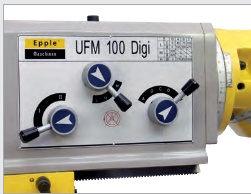
Bedieneinheit zur Einstellung der 11 Spindeldrehzahlen
