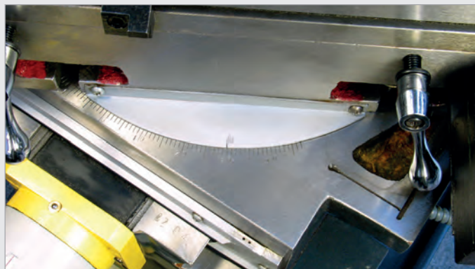
Kreuztisch 45° nach links und 45° nach rechts drehbar.
