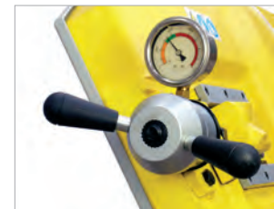
Anzeige für Sägebandspannung
