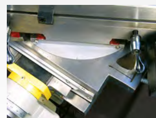
Kreuztisch 45° nach links und nach rechts drehbar
