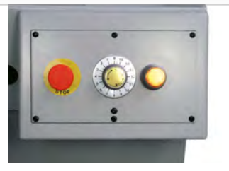
Der hydraulische Absenkyzylinder kann stufenlos über ein Handrad eingestellt werden
