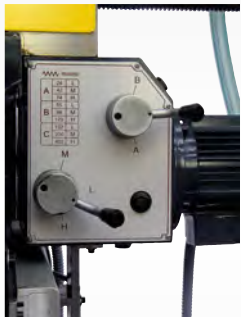
Abb.: X- und Y-Achse mit 9 Geschwindigkeiten
