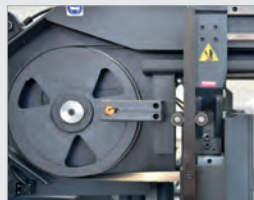
ABB.: NÄHERUNGSSCHALTER ZUR ERKENNUNG DES ABRUTSCHENS DES SÄGEBANDS
