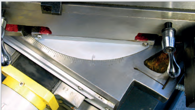
Kreuztisch 45° nach links und 45° nach rechts drehbar.
