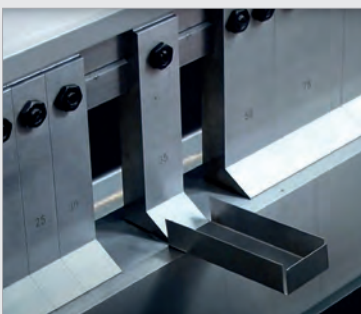
ABB.: SEGMENTIERTES BIEGEN DURCH HERAUSNEHMBARE SEGMENTE
