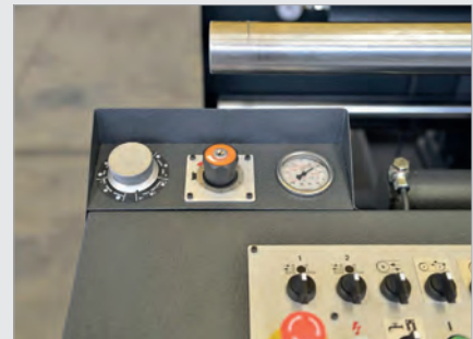
ABB.: SENSITIVE SCHNITTDROCKREGULIERUNG
