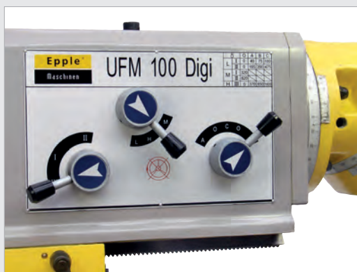
Bedieneinheit zur Einstellung der 11 Spindeldrehzahlen
