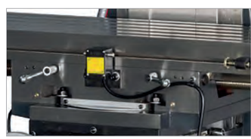
schwenkbar von -45° bis +45° Präzisionsschliff gehärteter Tisch
