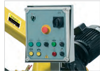
Drehbares und ergonomisch gestaltetes Bedienpult
