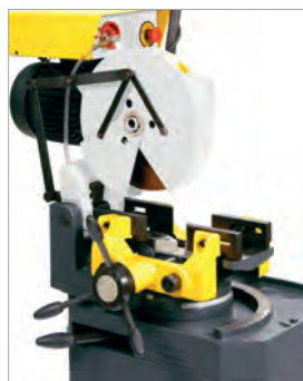
ABB.: Kopf zum Schlitzen um 90° gedreht
