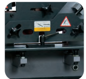
Flachstahlstation Tisch mit Winkelanschlägen und einstellbarem Niederhalter
