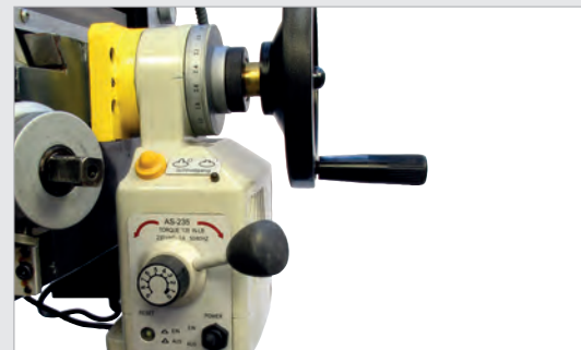
Y-Achse mit stufenloser Vorschubverstellung
