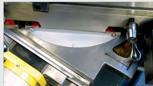
Kreuztisch 45° nach links und 45° nach rechts drehbar
