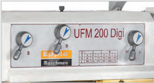
Bedieneinheit zur Einstellung der 12 Spindeldrehzahlen
