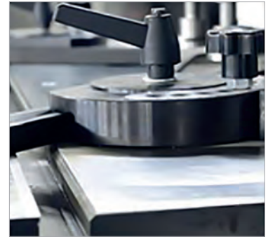
WINKELVERSTELLUNG NUR BEI MODELL E-HAM 6 VP
