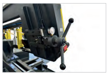
ABB.: HYDRAULISCH-MECHANISCHE BANDSPANNUNG
