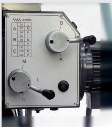
X- und Y-Achse mit 9 Geschwindigkeiten
