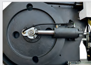
ABB.: HYDRAULISCHE SÄGEBANDSPANNUNG UND BOLZENSTEUERUNG
